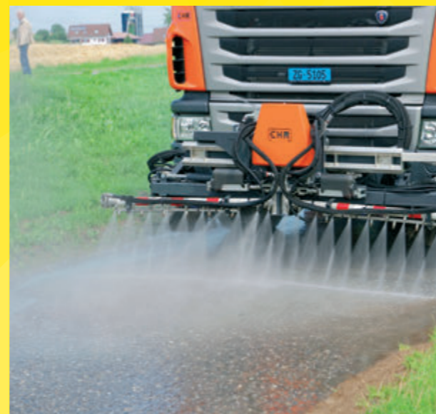
Waschbalken: steuerbar und effizient
