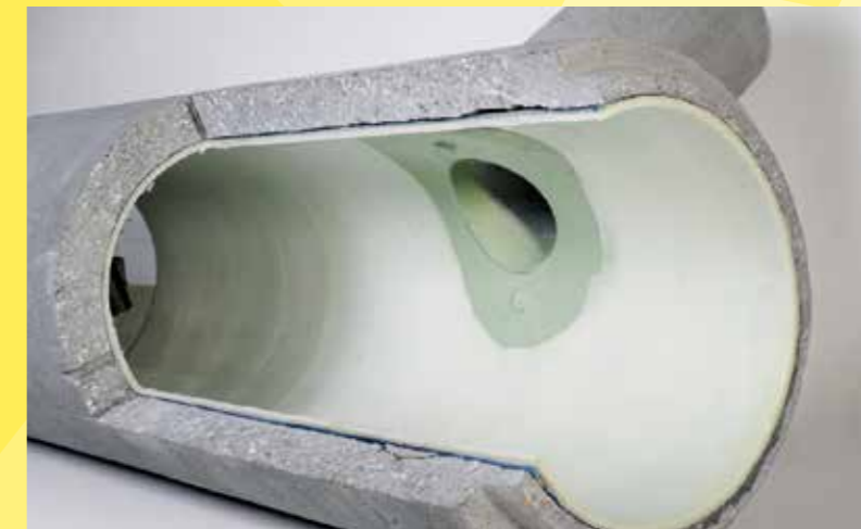
Fertiger, mit Epoxidharz eingebundener Einlauf
