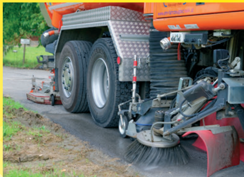
Wischmaschine: ferngesteuerte Präzision
