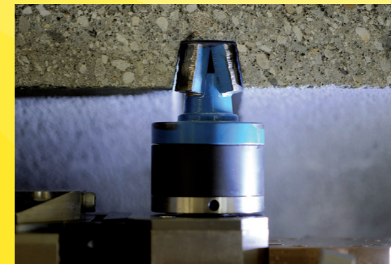
Einfräsen eines Schlitzes
